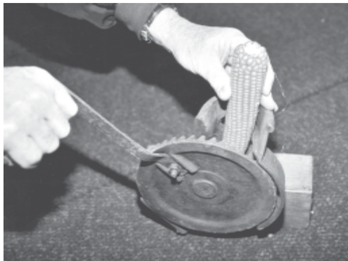
La “sgranalòva”, uno strumento semi-meccanico per sgranare le pannocchie. Rendeva il lavoro più veloce e meno faticoso.
